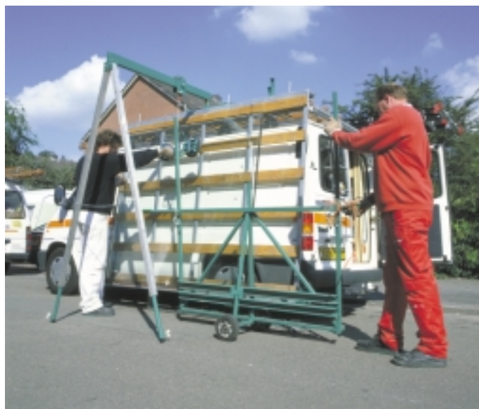
Bild 1: Bei dieser Konstruktion handelt es sich um einen höhenverstellbaren, schwenkbaren Ausleger, der am Fahrzeug fest installiert ist, sowie eine Schienenlaufkatze und höhenverstellbare Stützfüße. Manuelles Be- und Entladen ist damit nicht mehr erforderlich
