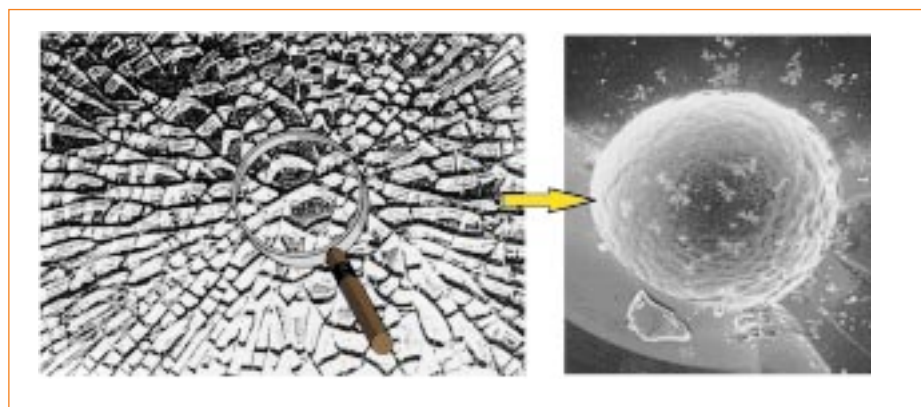
Bild 1: Bruchbild (links) und Verursacher: eine Kugel von ca. 0,2 mm Durchmesser
