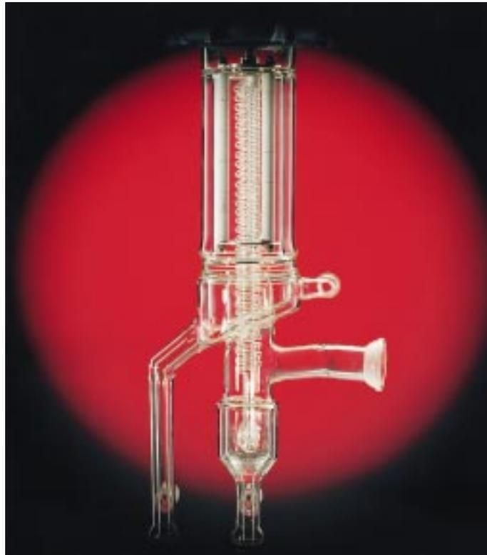
Die Ästhetik der Technik zeigt dieser Dünnschichtverdampfer zur Kurzwegdestillation
