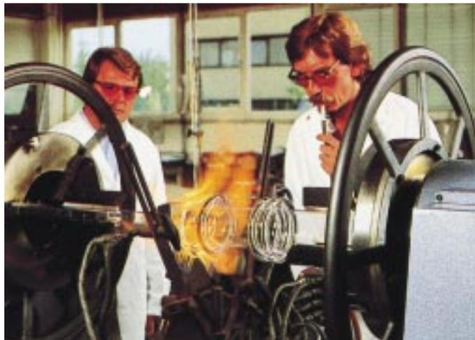
Glasbläserarbeit an der Glasdrehmaschine
