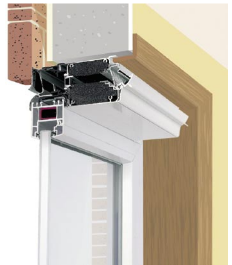
„Invisivent AK“ mit einer Bauhöhe von 59 mm und einer Luftleistung von 20 m 3 /m/h bei 10 Pa
